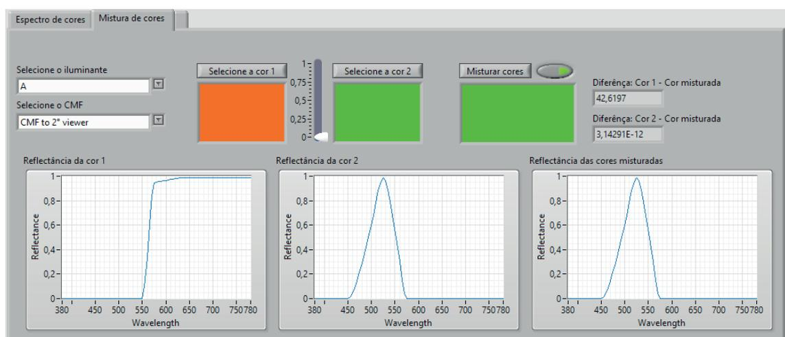
**Figura 4** – Interface do sistema para análise de mistura de cores.
