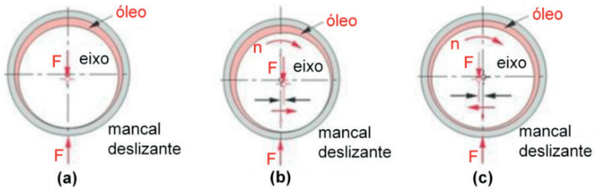
Figura 4 - Efeito cunha em um mancal radial. (a) Eixo em repouso; (b) início do movimento e (c) movimento desenvolvido
