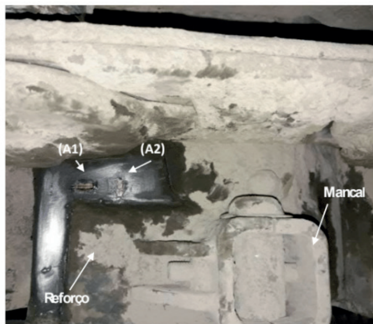
Figura 2. Os dois extensômetros axiais foram colados respectivamente no sentido do eixo de simetria do sistema (extensômetro A1) e no sentido transversal (extensômetro A2). Fonte: Autor (2017)
