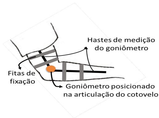
Figura 2: Esquema de posicionamento do goniômetro na articulação do cotovelo
