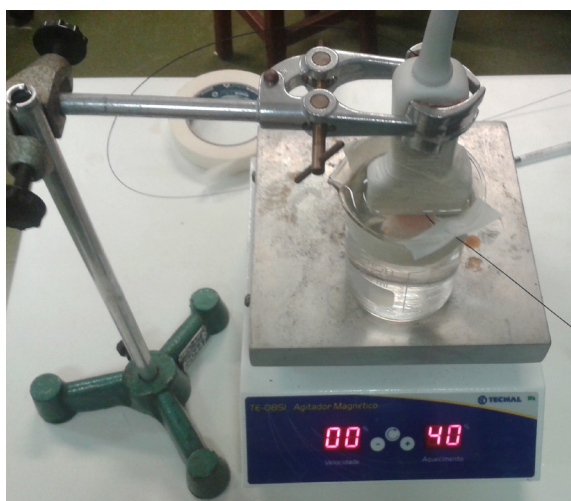
Figura 1: Foto do arranjo experimental, mostrando o suporte para fixação do transdutor, a placa aquecedora, o bquer a amostra e as sondas térmicas.
