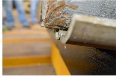
Figura 21 - Deslizamento do concreto nos apoios. Fonte: Elaborado pelos autores.
