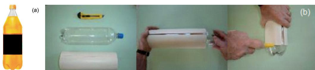
Figura 3: (a) Modelo de garrafa PET utilizada. (b) Processo de corte.
