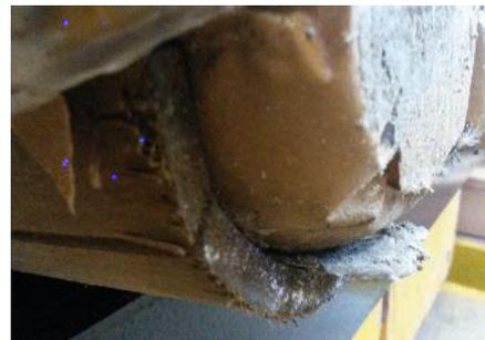
Figura 14 - Deslizamento da massa de concreto no apoio. Fonte: Elaborado pelos autores.
