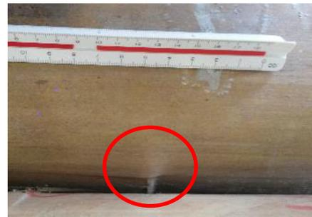
Figura 16 - Descolamento local do bambu no centro da laje. Fonte: Elaborado pelos autores.
