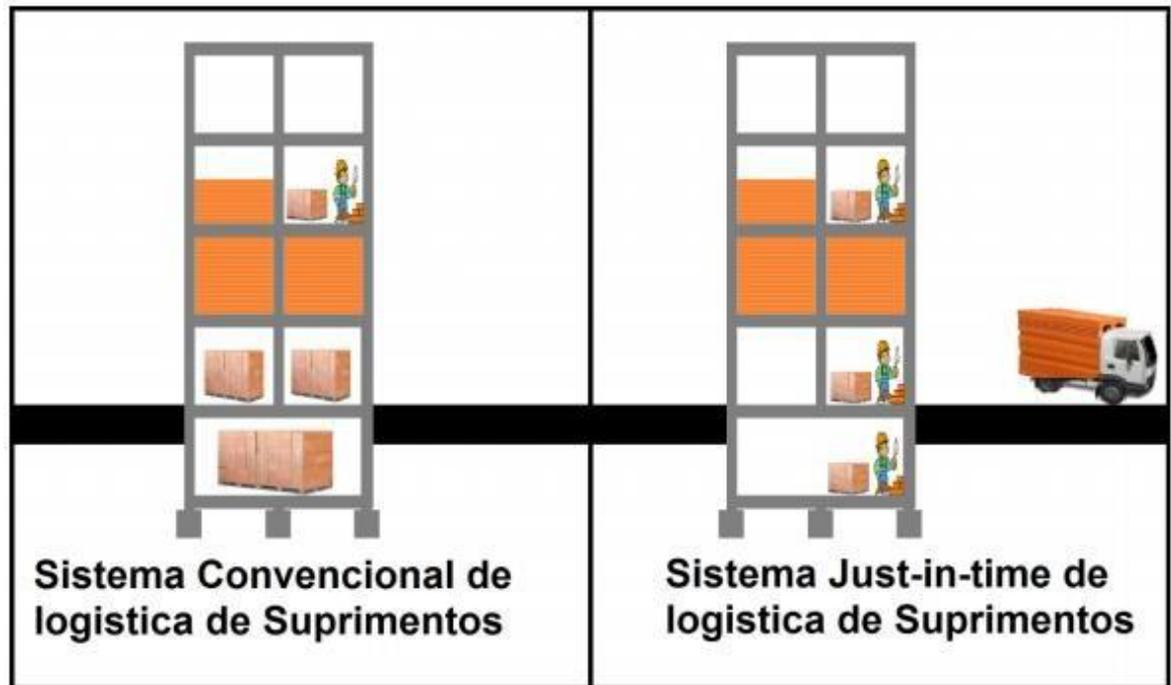
Figura 2: Comparativo entre uma logística de suprimentos convencional e uma logística de suprimentos baseada no Just-In-Time.
