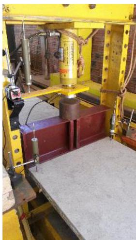
Figura 11 – Posições dos LVDT's. Fonte: Elaborado pelos autores.
