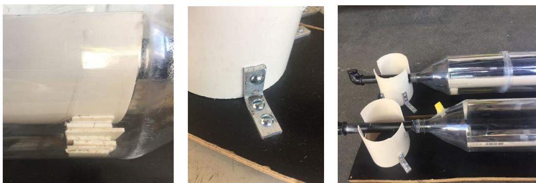
Figura 7: (a) Elevação em PVC. (b) Fixação da base. (c) Montagem.
