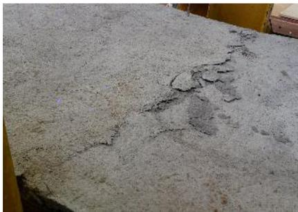
Figura 13 - Ruptura da capa de concreto. Fonte: Elaborado pelos autores.
