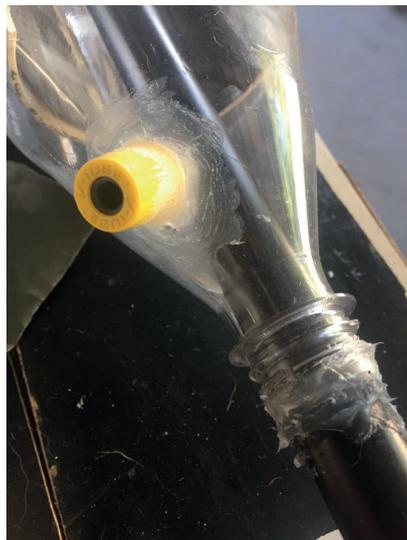
Figura 9: Válvula de vácuo em um dos coletores.
