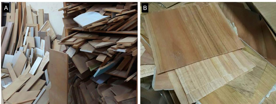
Figura 1: Resíduos das atividades do Laboratório de Móveis do IFFar – Campus Santa Rosa: A) resíduos de madeira e MDF; B) rejeitos de lâminas de madeira. Fonte: elaborado pelas autoras.
