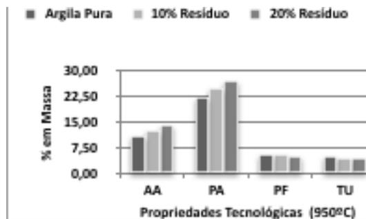
**Figura 03** - Gráfico das propriedades tecnológicas à 950°C (absorção de água, porosidade aparente, perda ao fogo e teor de umidade) em função a porcentagem em massa.
