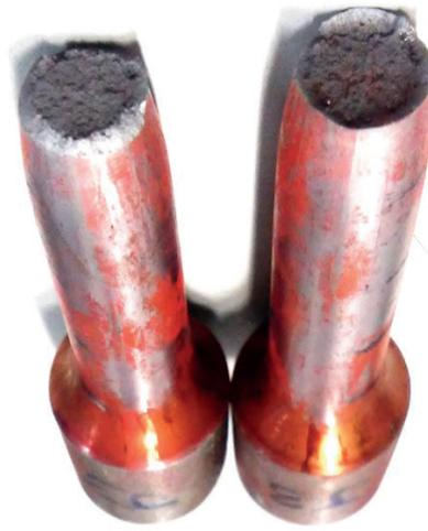
Figura 8. Amostra jateada - fratura dúctil.
