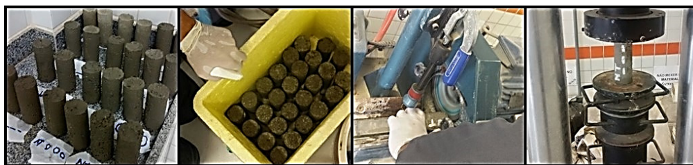
Figura 2 – Moldagem, regularização e rompimento dos corpos-de-prova.
