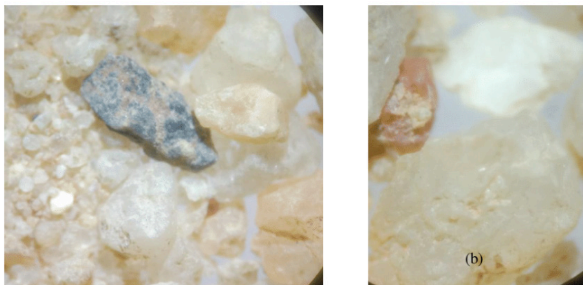
Figura 3. Morfologia dos grãos por microscopia óptica: (a) forma, (b) textura.
