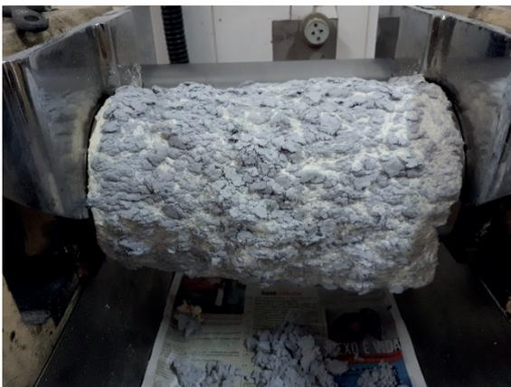
Figura 3 – Incorporando o resíduo de couro (carga)
