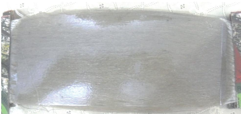
Figura 5 Placa de compósito de fibra de algodão.
