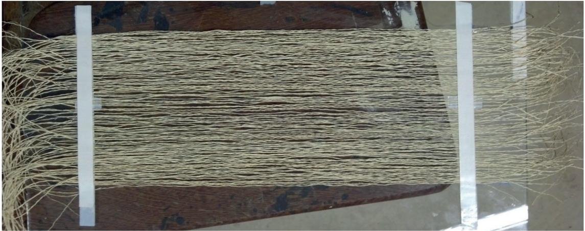
Figura 4. Resultado final do alinhamento das fibras.
