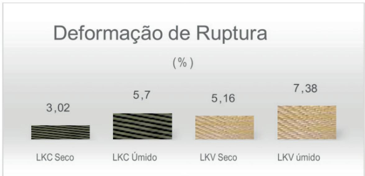
Figura 5 - Deformação de ruptura
