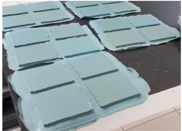
Figura 9 - placas após prensagem
