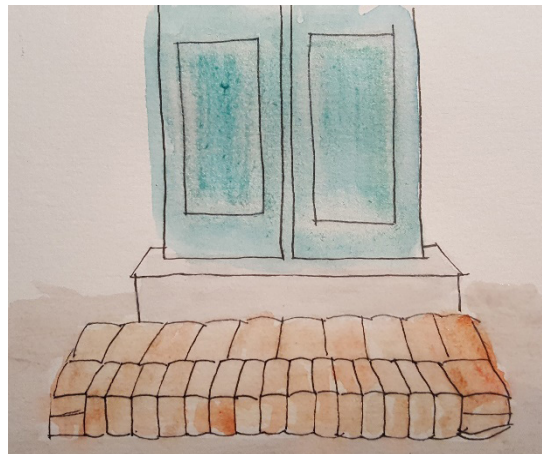
Figura 10 – Croqui dos degraus de acesso ao casarão feito em tijolos.
