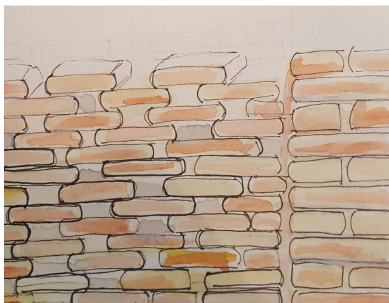
Figura 11 – Croqui dos parede de tijolos vazados na olaria. Nota-se a diferença entre os tamanhos dos tijolos de vedação e dos tijolos dos pilares.
