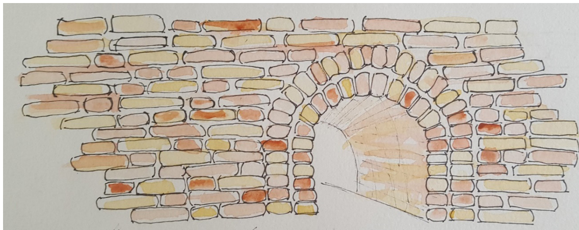
Figura 5 – Croqui do forno de queima da Olaria. Mostrando a parede de 90 cm de espessura. Fonte: autora.
