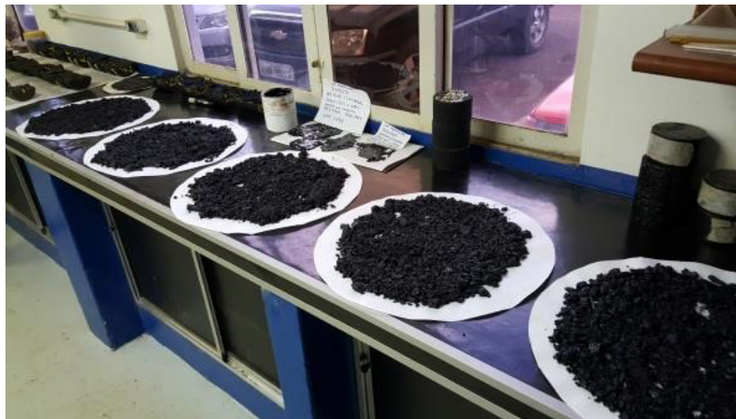
Figura 2.2 – Mistura Asfáltica em filtros para o resfriamento natural
