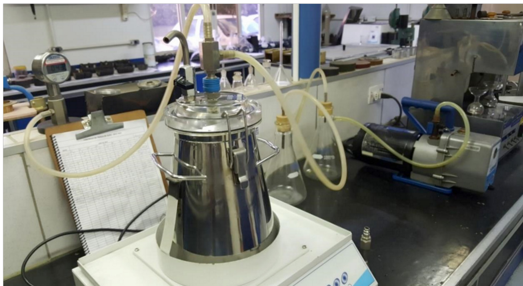
Figura 2.3 – Kitasato Metálico posicionado na mesa agitadora e ligado ao motor a vácuo
