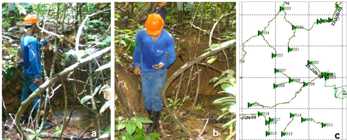
Figura 4: (a) Mapeamento de nascentes; (b) mapeamento dos cursos d'água com uso do receptor GPS de alta sensibilidade; (c) arquivo do receptor GPS com linhas e pontos representando igarapés e nascentes, respectivamente.
