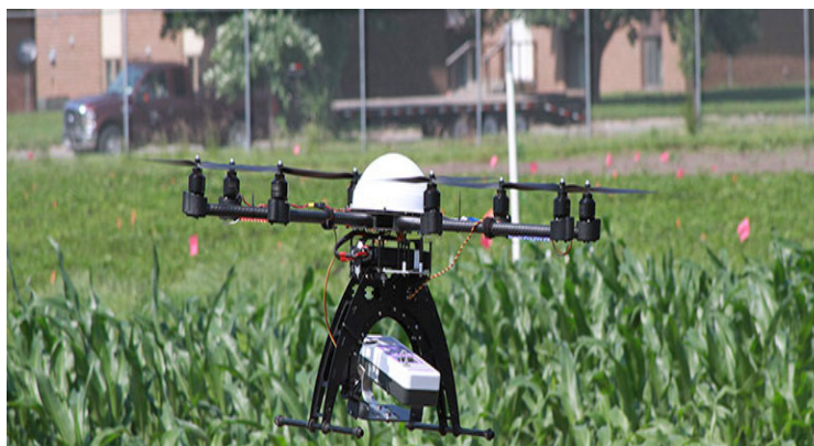
Figura 8. Sensor ativo de dossel embarcado em VANT. http://hollandscientific.com/
