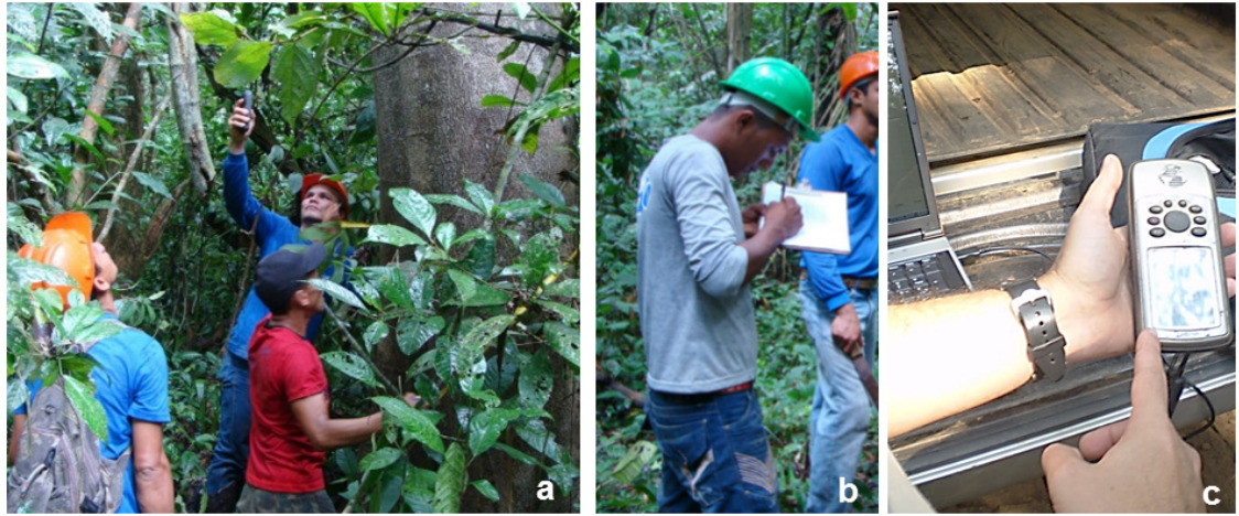
Figura 3: (a) Mapeamento das árvores de interesse com uso de receptor GPS de alta sensibilidade; (b) registro das informações de diâmetro, altura, espécie, qualidade do fuste, número da placa e número do GPS de cada indivíduo; (c) transferência dos pontos do receptor para o computador.
