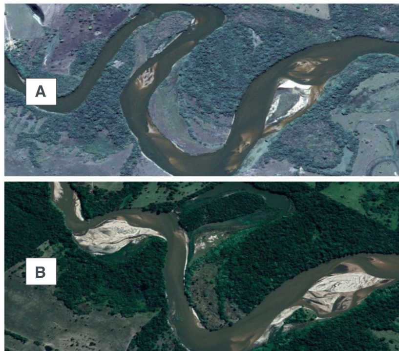
Figura 1 - Assoreamento no Rio Coxim destacado por flechas (A e B) e abandono de meandro (B) destacado pelo círculo, coordenadas geográficas 18^{\circ}36'01.43''\text{S} e 54^{\circ}41'35.62''\text{O} . (A) Imagem retirada em 05/2006. (B) Imagem retirada em 10/2016.
