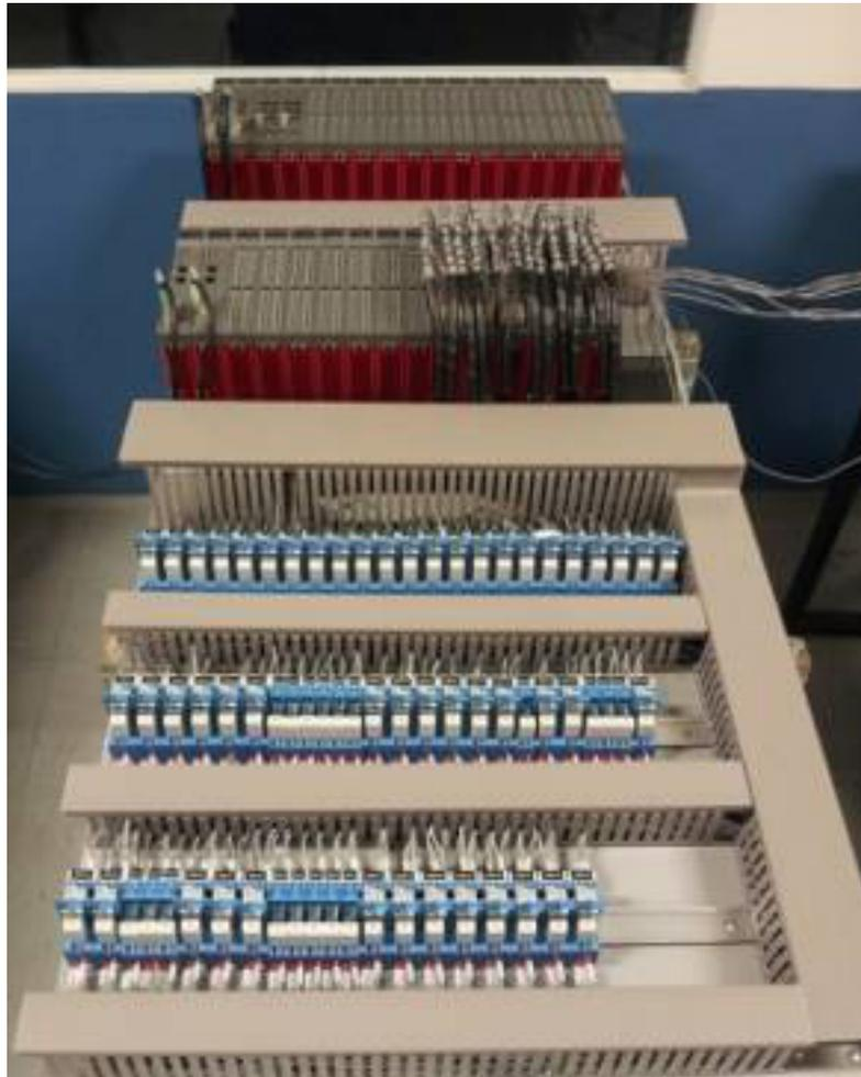
Figura 5: Placa de Montagem Painel da Unidade de Controle Digital (novo)
