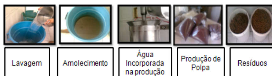
Fluxograma 1 - Processo Produtivo da Polpa de Açaí.
