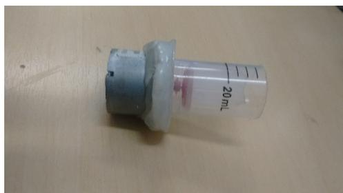
Figura 4. Corpo da seringa e o êmbolo (ROTOR) fixos ao motor com a cola quente, IFPE,2016.
