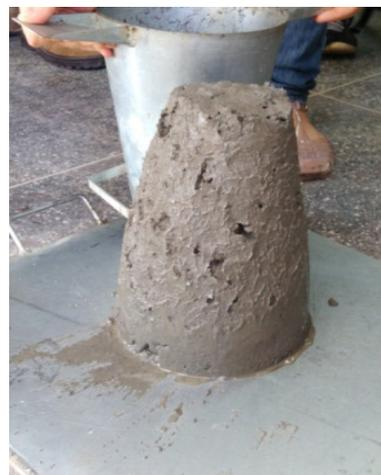
Figure 5: Ensaio de abatimento de tronco de cone
