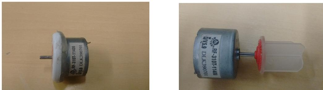
Figura 3. Fixação do o êmbolo (ROTOR) no motor. IFPE, 2016.
