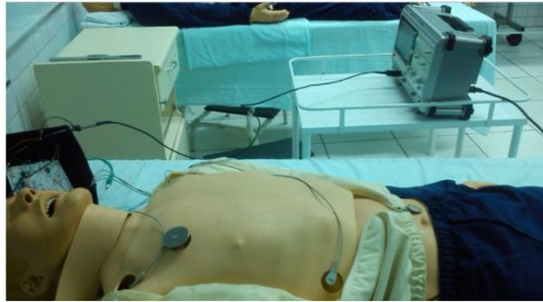
Figura 5 – Aquisição do sinal de ECG em um simulador clínico de alta fidelidade no laboratório de simulação de UTI do IFRR.
