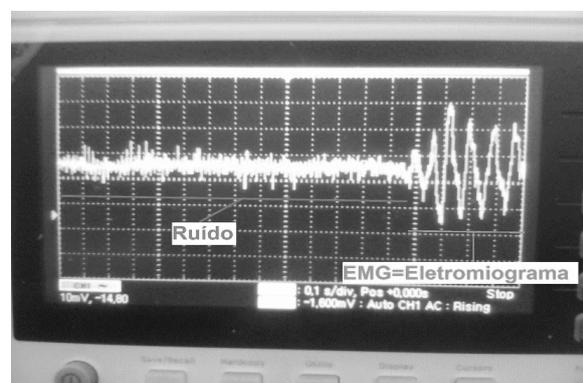
Figura 8 – Sinal captado pelo protótipo de eletromiógrafo projetado.
