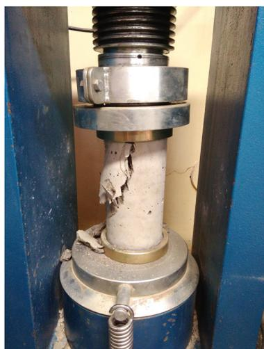
Figura 6: Ensaio de compressão
