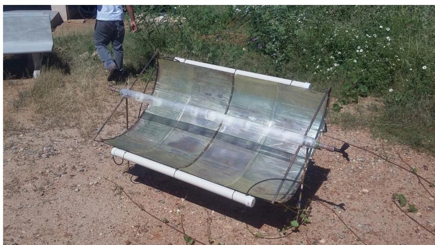
Figura 8. Reator Fotolítico com sistema de minibomba. IFPE, 2016.
