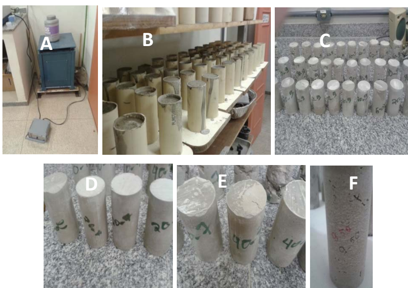
Figura 21: Mesa vibratória utilizada na homogeneização dos pós em A, corpos de prova em sala de cura em B, corpos de prova desmoldados em C, corpos de prova de 20-700-PCR em D, e de 40-700-PCR em E, e corpo de prova de 50-900-PCR em F.
