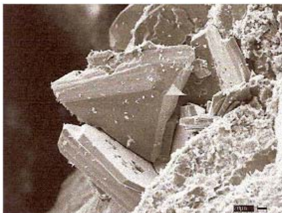
Figura 10: Cristais de hidróxido de cálcio (portlandita) formados na hidratação do cimento Portland [43].
