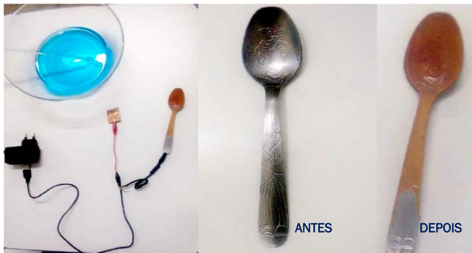
Figura 3. Sistema eletrolítico (esquerda), colher antes da cobreação (centro) e após a deposição de cobre (direita)
