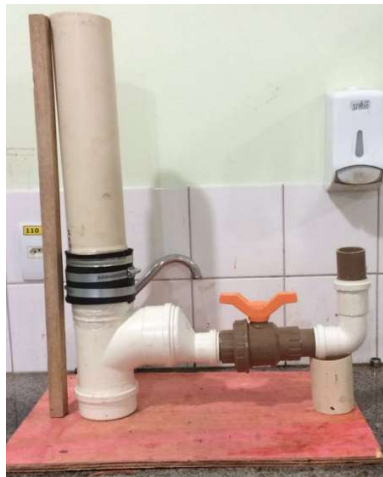
Figura 3: Permeâmetro de carga variável
