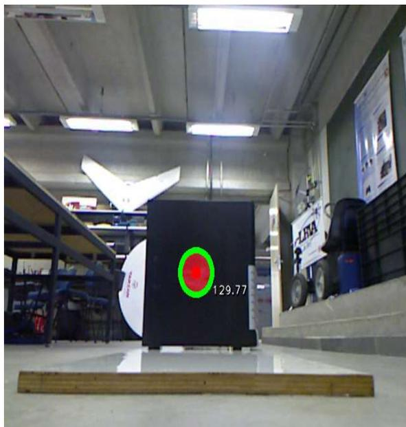
Figura 6: Visão do sensor e determinação da distância do objeto em cm.
