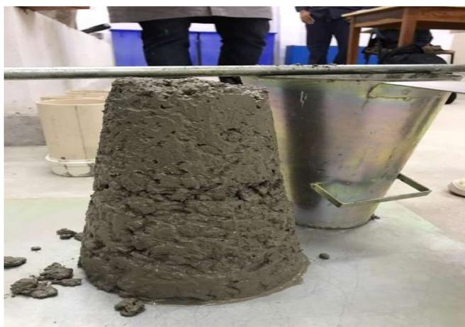
Figura 4 - Slump Test
