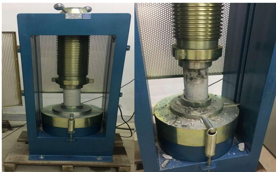
Figura 6 - Concreto antes e após rompimento
