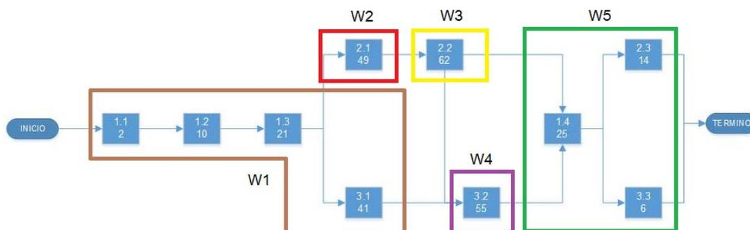
Figura 3 – Arranjo das estações de trabalho do processo de montagem e desmontagem do sistema de formas.
