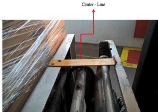
Figura 9 - Center line: Posição correta do equipamento
