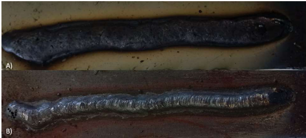
FIGURA 10 – Escória e cordão de solda realizado com o segundo dispositivo utilizando eletrodo E7018.
