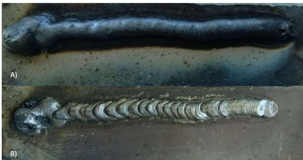
FIGURA 9 – Escória e cordão de solda realizado com o terceiro dispositivo utilizando eletrodo E6013.
