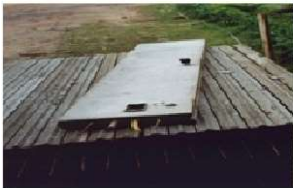
Figura 5. Placa de concreto com aplicação da fibra de bambu. Fonte: Autor, 2016.
