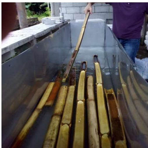
Figura 3. Bambu em lasca, com suas fibras, para extração química pelo processo de polpação tipo Kraft.
