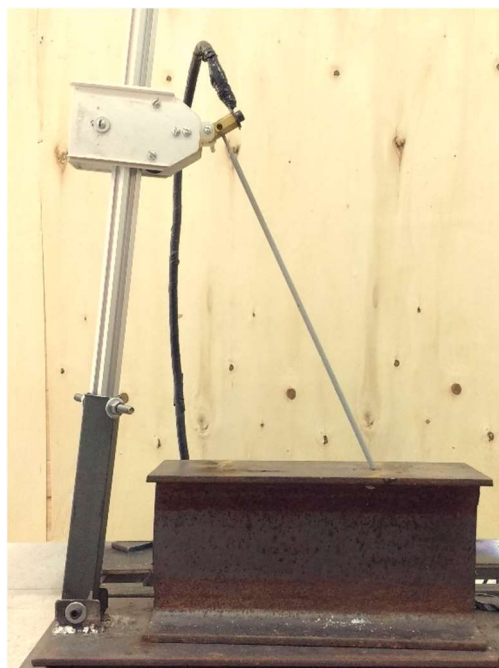
FIGURA 8 – Dispositivo de soldagem com eletrodo revestido por gravidade fabricado. Fonte: Autores.
