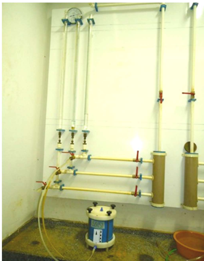
Figura 3. Conjunto utilizado para a realização dos ensaios de permeabilidade de carga variável, formado pelo permeômetro e as buretas graduadas.
