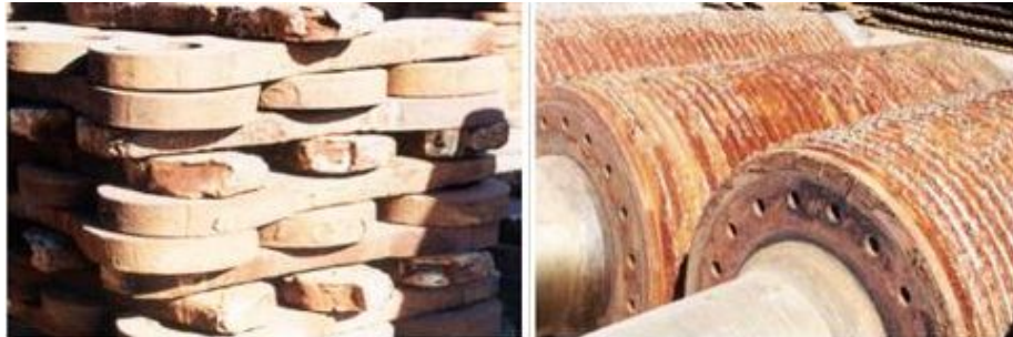
Figura 6: Ilustração dos desgastes dos martelos do desfibrador e dos rolos de moenda (Fonte: SBA; STAB; CTC; 2012).
