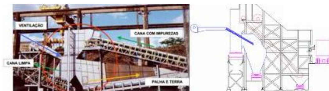
Figura 4: Sistema de limpeza a seco da cana de açúcar (Fonte: SBA; STAB; CTC, 2012).
