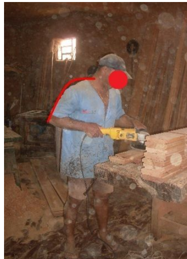
Figura 5.2 - Trabalho realizado sem EPI
