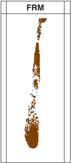
FIGURA 04: Cromatograma da FRM usando como eluente Hex/AcOEt (1:1) revelado com vapores de iodo.
