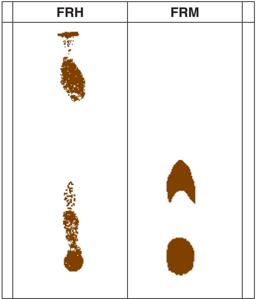
FIGURA 03: Cromatograma da FRM e FRH usando como eluente Hex/AcOEt (9:1) revelado com vapores de iodo.
