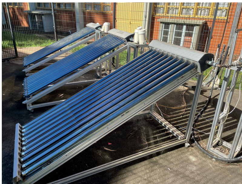
FIGURA 4. Sistemas de três coletores solares de tubos evacuados assistidos por termossifões.
