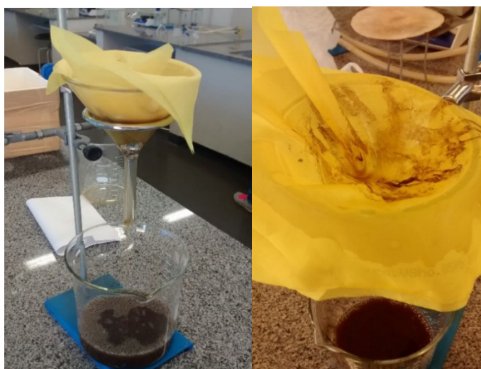
Figura 4: Esquema de filtração da vinhaça.
