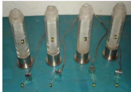
Figura 3 – Fotos do pivôs e das placas metálicas superiores
