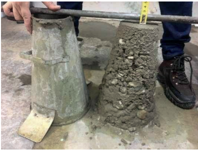
Figura 11 – Abatimento para o traço de Referência [Autoria própria]
