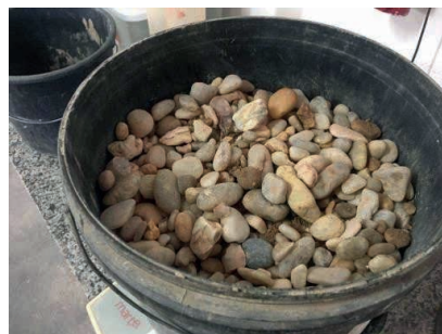
Figura 2 – Agregado graúdo (Seixo) [Autoria própria]
