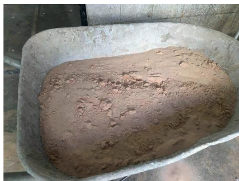
Figura 3 – Agregado miúdo (Areia) [Autoria própria]
