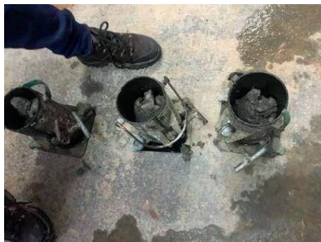
Figura 6 – Moldagem de corpo de prova [Autoria própria]
