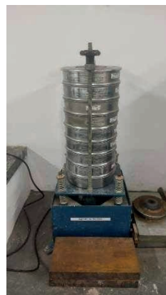
Figura 8 – Ensaio de peneiramento [Autoria própria]
