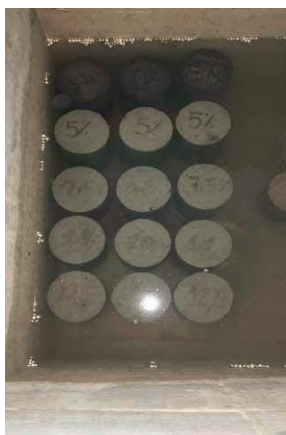
Figura 7 – Cura úmida [Autoria própria]
