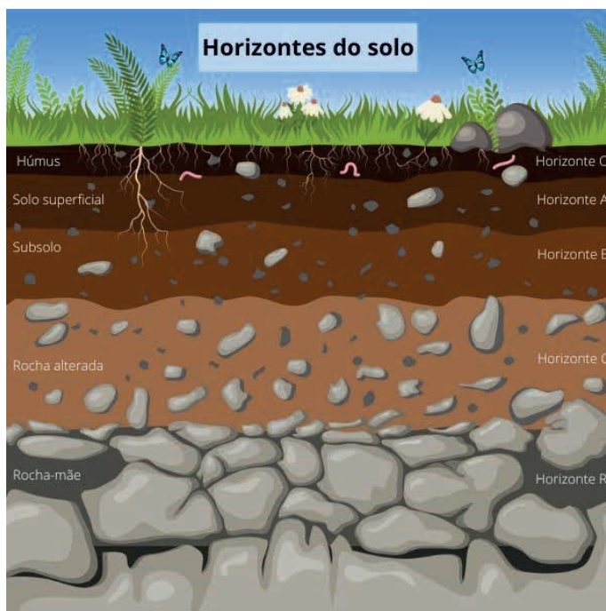
Figura 3.1- Exemplo de perfil do solo com seus diferentes horizontes.
