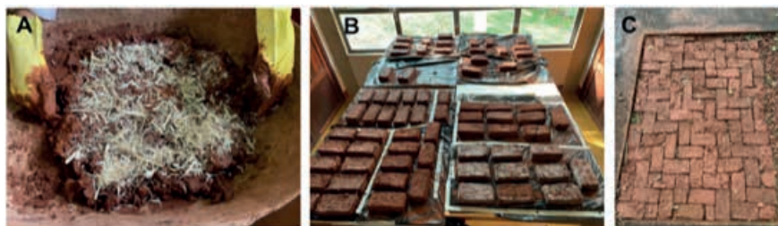
Figura 4 – Processo de fabricação dos tijolos ecológicos
