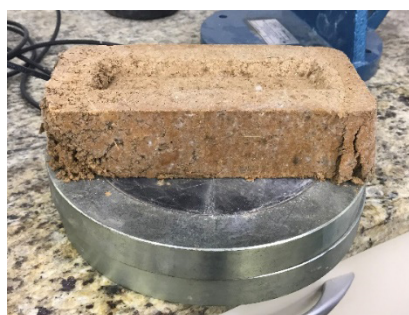
Figura 13. Tijolo depois do teste de compressão
