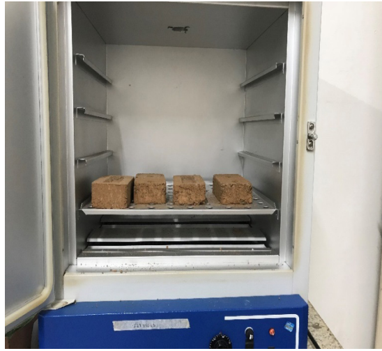
Figura 7. Tijolos sendo secos na estufa
