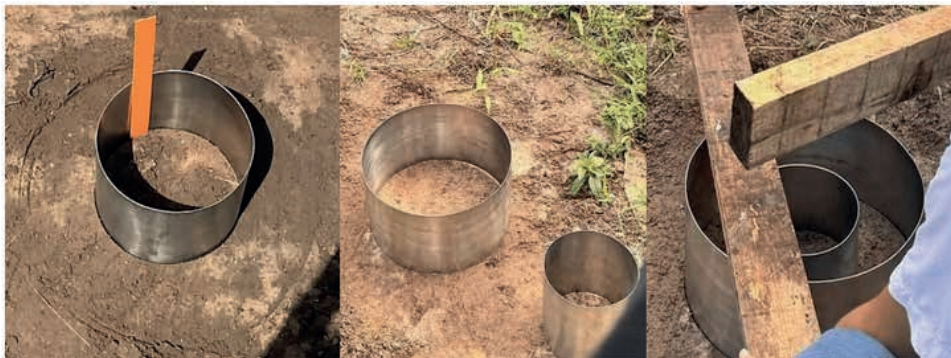
Figura 2. Cilindros utilizados para infiltração de água em Latossolo Amarelo, UFRA – Capanema, 2024.
