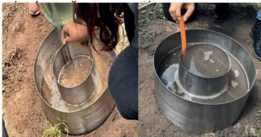
Figura 3. Aplicação de água nos cilindros, para determinar a velocidade de infiltração.
