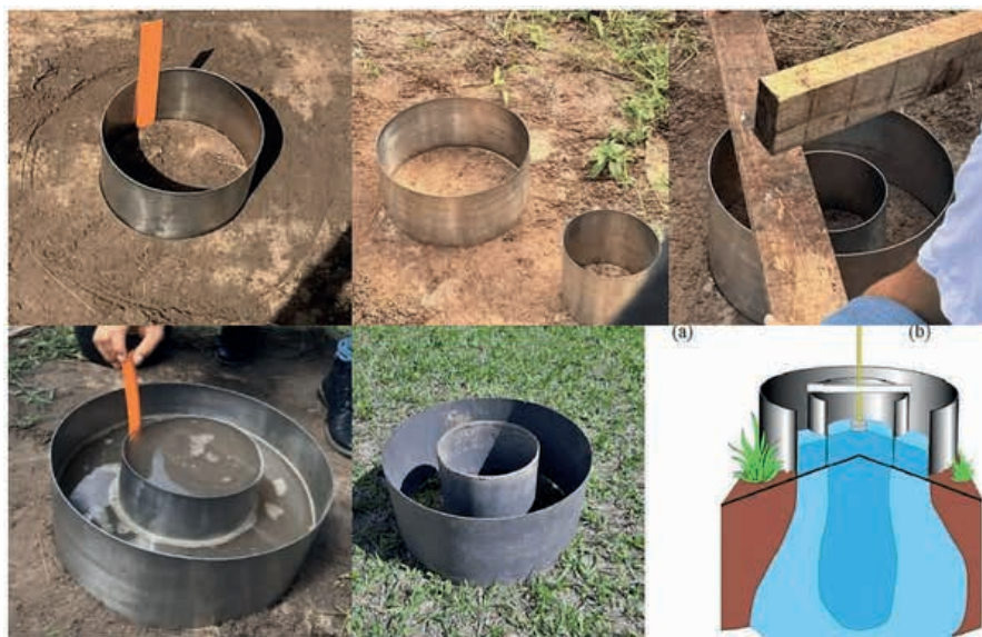
Figura 2 – Infiltrômetro dos anéis instalados em Latossolo Amarelo, UFRA – Capanema, 2024 e a leitura da lâmina de água em régua e a ilustração do perfil de infiltração da água no solo.
