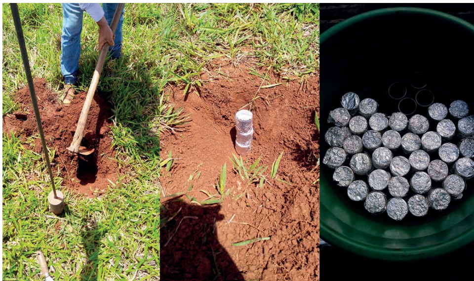
Figura1. Coleta de amostra de solo indeformada para avaliação de densidade, macroporosidade, microporosidade e volume total de poros (VTP).
