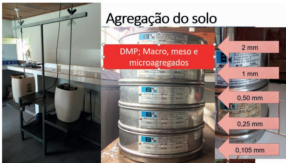
Figura 2. Agitador Tipo Yoder para avaliação da estabilidade de agregados em água.
