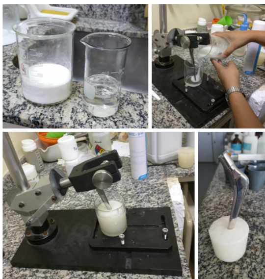
Figura 11. Esquema de preparação da base de apoio do implante.
