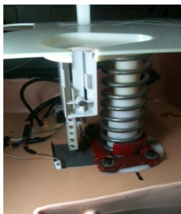
Figura 2 - mostra esta peça localizada no interior do tórax do manequim Ressuci Anne®, com o potenciômetro acoplado na UICV, podendo-se observar a marcação dos centímetros na peça.
