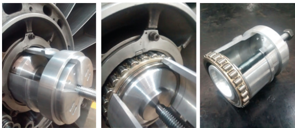
Figura 14. Herramienta extractora en operación con la presentación parcial y total del rodamiento No.1 del Motor turbofan JT8D
