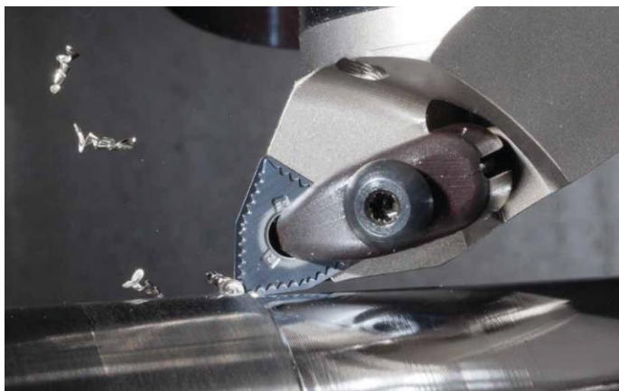
Figura 11. Imagem real de um insert de metal duro com cobertura de carbonitreto em operação de torneamento. Adaptado de (WIDIA, 2020).
