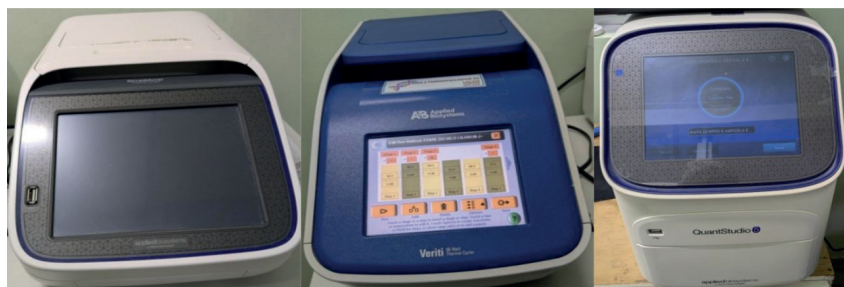
Figura 3: Termocicladores. A) PCR convencional B) RT-PCR (Arquivo pessoal).
