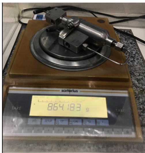
Figura 3: Balança semi-analítica utilizada para a pesagem precisa das amostras de petróleo.
