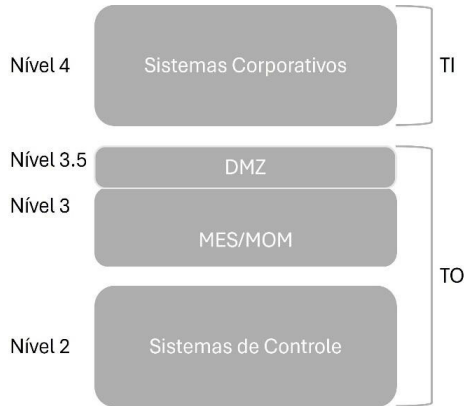
Figura 1 – Arquitetura definida pela Rotina Operacional do ONS com base no Modelo Purdue (ISA-99).
