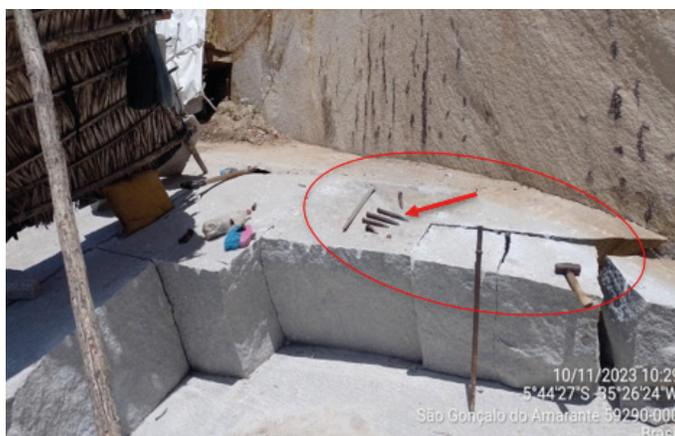
Foto 04. Ilustração de ferramentas e método manual de extração, Serrinha/RN.
