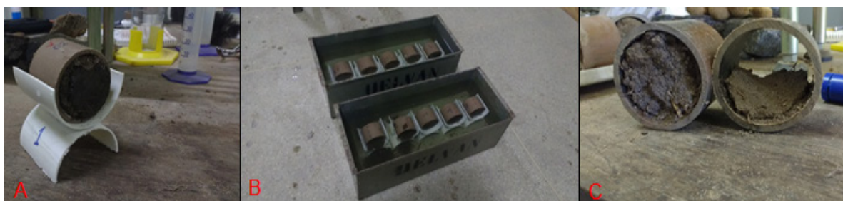
Figura 7. (A) Amostra acoplada ao suporte; (B) Conjunto de amostras/suportes dentro de um recipiente imersos com água; (C) Amostra indeformada desprendida seca.
