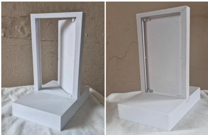
Figura 7 – Modelo 3D da porta impresso na impressora Cliever CL2.5.
