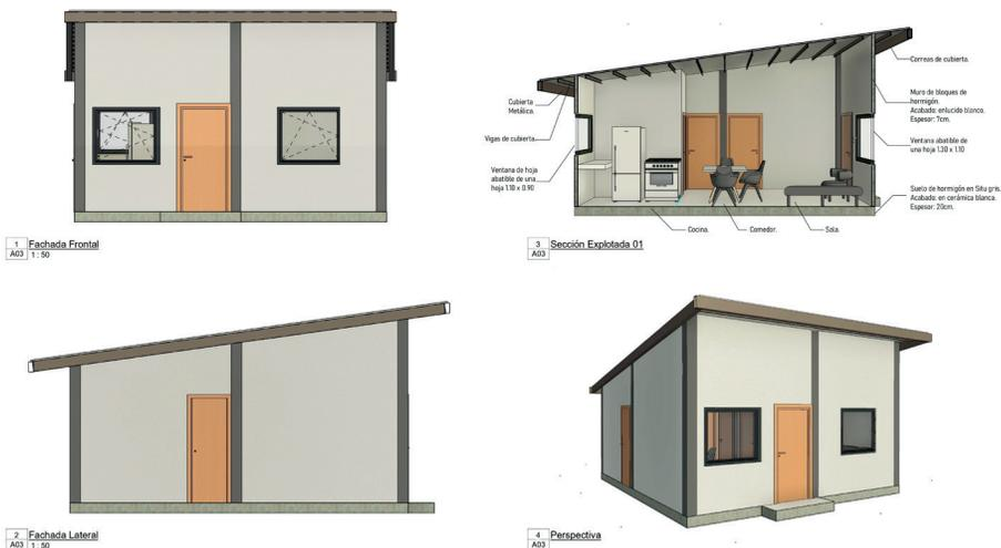
Fig. 7 Alzados, perspectiva y sección fugada de vivienda unifamiliar tipología Costa.
