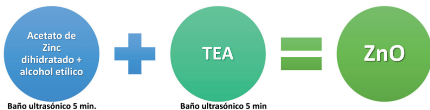
Figura 4. Diagrama esquemático del proceso de síntesis de ZnO.
