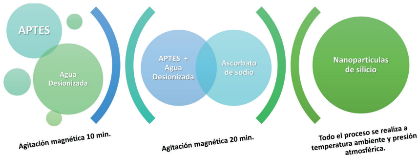
Figura 5. Diagrama esquemático del proceso de síntesis de las nanopartículas de Silicio.
