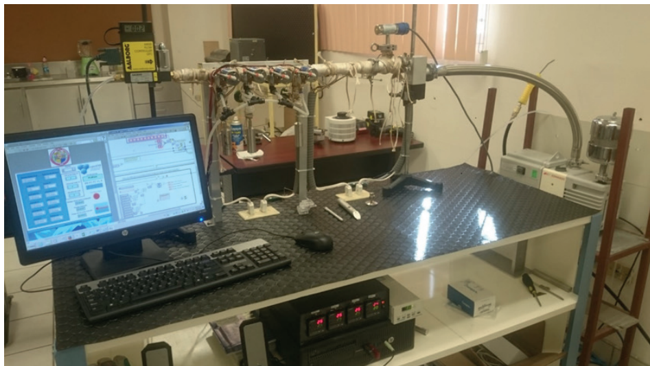
Figura 15. Sistema ALD Térmico completo y funcional.
