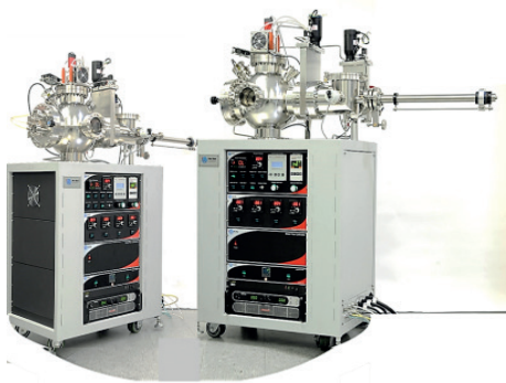
Figura 1. Reactor Hot Filament Chemical Vapor Deposition (HFCVD) de la compañía Blue Wave (Vispute, 2023).
